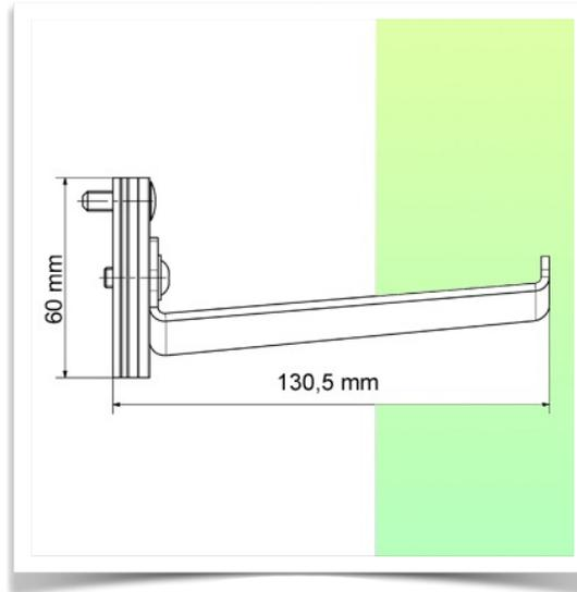
Support Universel pour scanner à codes barres.
